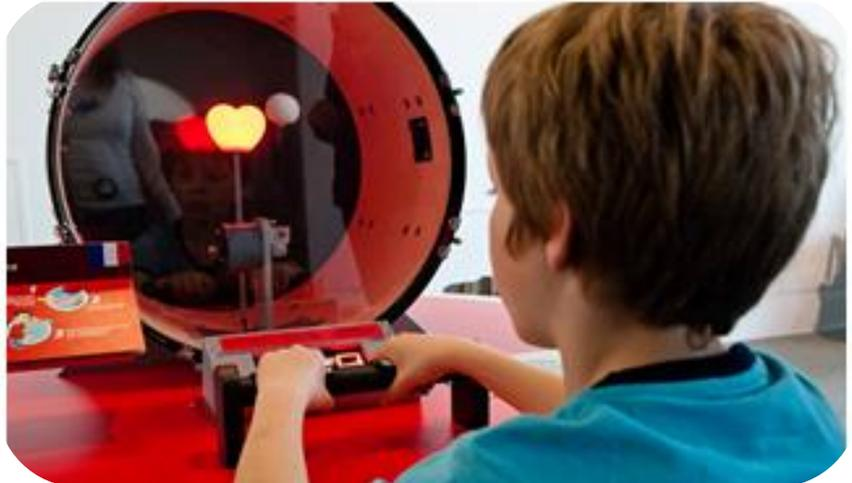
Cet élément propose de prendre conscience du rythme de son cœur. Il permet de l'écouter et de le visualiser grâce à un mécanisme qui amplifie le phénomène, via une grosse caisse, et qui donne une mesure chiffrée des battements du cœur.
